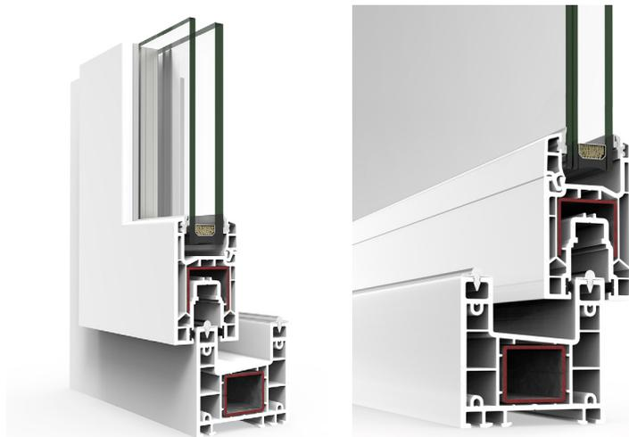
Sistema de ventana y balconera correderas de 70 mm de profundidad de marco y una capacidad máxima de acristalamiento de 24 mm. Con un valor de transmitancia térmica de ventana que va desde 1,3 W/m<sup>2</sup>K, presenta un alto grado de eficiencia energética.
